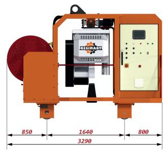
Medidas correspondientes a una máquina con disco de Ø900mm, para alturas de producto de hasta 300mm. (\*) Según modelo
