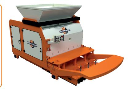
Máquina para fabricar prefabricados de hormigón pretensado mediante vibro-compresión, admitiendo todo tipo de productos hasta 400 mm de altura.
